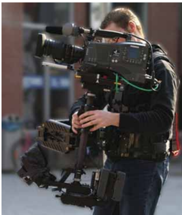
Estabilizador steadicam , parecido al utilizado en el rodaje de El resplandor
